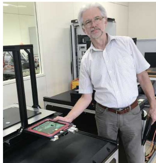
Pilot einer induktiven Ladestation für E-Mobile: Josef Brusa hält die kleine Platte, die in den Unterboden des Autos eingebaut wird.
