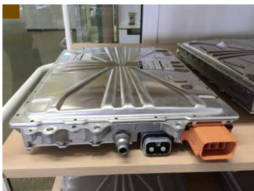
Ladegerät mit 22 kW Leistung, das beispielsweise im Elektro-Smart eingebaut wird.
